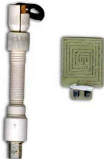
Figura 7 – Foto do sensor e do conector que foram utilizados nos experimentos. O sensor, construído sobre uma placa de circuito impresso, tendo as suas pistas de cobre e estanho, possui 35 mm de altura por 30 mm de comprimento.
